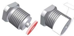
Dans tous les deux cas il est nécessaire de procéder au torçage à l'aide de deux clés, l'une placée sur les parties planes du raccord au processus de l'instrument et l'autre sur celles de la prise de pression. Ne jamais utiliser le boîtier comme moyen de serrage car cette opération pourrait endommager l'instrument. Au moment de la première mise en pression il faut vérifier que le raccord soit à tenue étanche.
